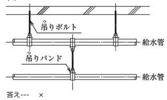
下部の配管支持が上部の管の中央部により支えられている。これでは上部管に荷重がかかり、流れが阻害されたり、場合によっては破損の可能性がある。下管の吊りバンドを上部吊りボルト位置と揃える。(過去問24年)
